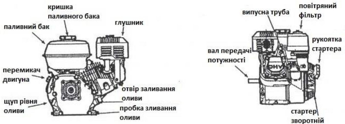
Мал. 2 Основні вузли двигуна швонарізувача
